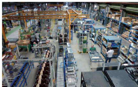
> Vue aérienne de la ligne permettant de visualiser la structure existante afin nous aider à remettre en cause la circulation dans la ligne, l'infrastructure d'énergie et les moyens de manutention.
